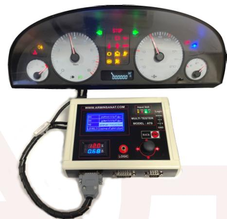
بعد از نصب وارد منوی تست صفحه کیلومتر شوید، گزینه های برق ۱۲ ولت و برق سوئیچ را در حالت ON قرار دهید تا برق وارد صفحه کیلومتر شما شود. در ادامه برای تست سرعت خودرو و دور موتور عدد این گزینه را بالا و پایین برد که به صورت همزمان بالا رفتن یا پایین آمدن عقربه های صفحه کیلومتر خود را مشاهده می کنید. همچنین برای تست آمپر آب و آمپر بنزین می توانید گزینه میزان دمای آب و بنزین را در سطح LEVEL های مختلف قرار دهید و به صورت همزمان تغییرات آن ها را مشاهده می نمایید.
